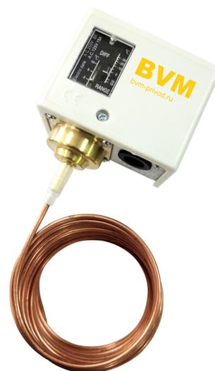
**ПРИНЦИП ИЗМЕРЕНИЯ И РАБОТЫ.** Когда температура в зоне нахождения капилляра превышает установленное значение (см. график), контакты 1-3 замыкаются, а контакты 1-5 размыкаются (точка I). Контакты возвращаются в исходное положение, когда температура падает ниже значения, равного уставке минус значение гистерезиса (точка II).
